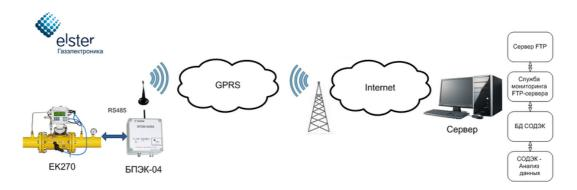
Устройство связывается с сервером сбора и обработки данных по каналам GPRS через интернет. Сервер с установленным программным модулем «СОДЭК-GPRS» должен иметь статический IP-адрес.
